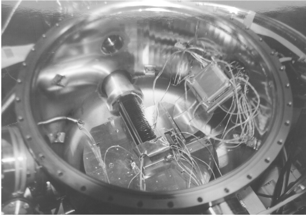
Abbildung 9.10: Blick in die Experimentierkammer. Zu sehen sind die Ringe des Extraktionsabschnitts des Rückstoßionenionenimpulsspektrometers. Um dem Elektronendetektor herum ist eine Abschirmung gebaut. Das 127^\circ - Zylinderspektrometer in Strahlrichtung ist ebenfalls gut sichtbar.
