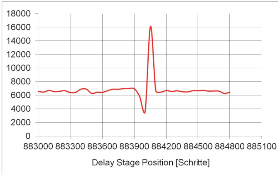
Abbildung 5.20: Die Null-Delay-Position der Verzögerungsstufe, bei der die Pump- und Probe-Strahlen zeitlich überlappen. Die absolute Position der Verzögerungsstufe ist gegen die Anzahl der Argon-Ionisationsereignisse aufgetragen. Bei der Null-Delay-Position addieren sich die Intensitäten beider Strahlen, sodass die Ionisationsrate von Argon ein Maximum aufweist.
