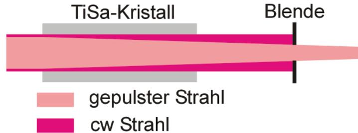
Abbildung 2.8: Prinzip der Kerr-Linsen Modenkopplung in einem Ti:Saphire-Laser [46]. Die starken Intensitäten der durch eine kurze Störung in dem Resonator initiierten Pulsen werden in dem Verstärkerkristall stärker fokussiert als die niedrigen Intensitäten der kontinuierlichen Laserstrahlung (CW: continuous wave). Die Trennung verschiedener Intensitätsanteile findet mit Hilfe geeigneter Lochblenden statt, wodurch ein stabiler gepulster Laserbetrieb erzeugt wird.
