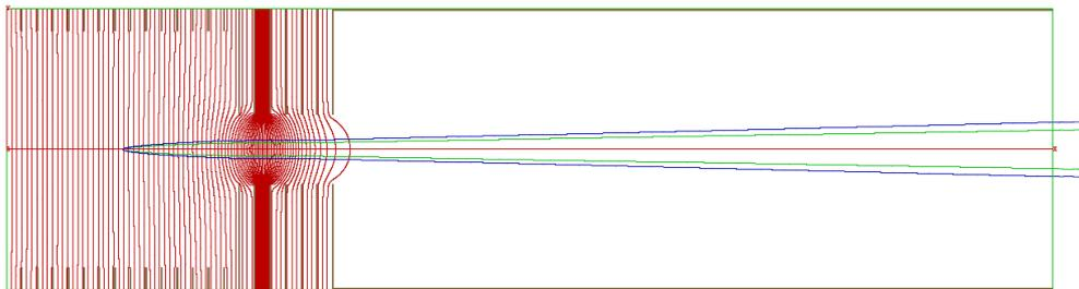
Abbildung 3.14: Spektrometer mit elektrischen Feldlinien inklusive vier Ionen-Trajektorien mit verschiedenem Anfangsimpuls. Zwischen der 16. und 17. Platte ist die elektrostatische Linse zu erkennen.
