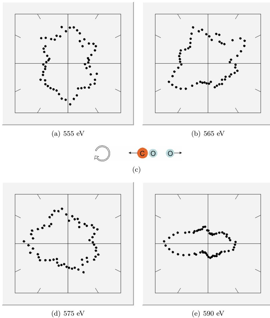
**Abbildung 6.4:** Aufgetragen ist der Phi-Winkel  $\phi^{ePhoto}$  des Photoelektrons. Der zugehörige Theta-Winkel  $\theta_x^{ePhoto}$  ist auf  $60^\circ$  bis  $120^\circ$  eingeschränkt. Die Molekülachse ist mit der durch  $0^\circ$  und  $180^\circ$  definierten Ebene identisch. Es wird eine Detektorfläche mit Radius 20 mm genutzt.
