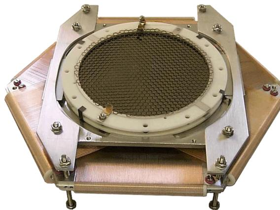
Abbildung 1.3.: Bild eines Detektors mit MCP und Hexanode. Quelle: RoentDek Handels GmbH
