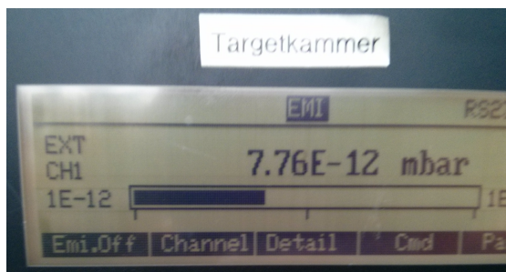
Abb. A.1.: Restgasdruck der Reaktionskammer nach Ausheizen der Kammer und Einsatz von Getterpumpe und Kühlfalle während der Strahlzeit am FLASH.
